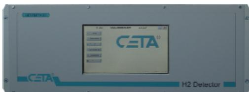
Formiergas (5 % Wasserstoff, 95 % Stickstoff) verwendet. Damit lassen sich Leckraten bis zu  $1 \cdot 10^{-5}$  mbar\*l/s (entsprechend  $6 \cdot 10^{-4}$  ml/min) nachweisen. Hierbei wird die austretende Gasmenge (Konzentration) gemessen, welche proportional zur Leckgröße ist. Das Prüfteil kann mit einem Druck von bis zu 12 bar (alternativ
