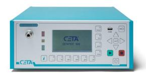
auf die Erkennung von geringsten Volumenunterschieden optimierte Messtechnik eingesetzt. So lassen sich in einem Volumen von 10 cm³ Volumenunterschiede von nur 0,03 cm³ prozesssicher auflösen (0,03 cm³ entspricht dem Volumen eines O-Ringes mit 12 mm Durchmesser und 1 mm Schnurstärke).
