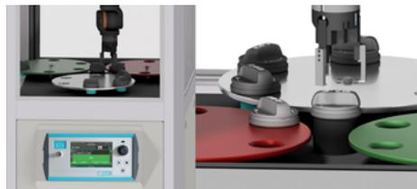
In Abhängigkeit vom Prüfergebnis (i. O. / n. i. O.) erfolgt die Umlagerung der Produkte wiederum per Roboter auf Magazine mit Aufnahmeplätzen für Gutteile bzw. für Schlechteile.
