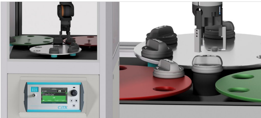
Prüfstand zur Dichtheitsprüfung von Tankdeckeln - Links : Ausschnitt aus Prüfzelle mit Dichtheitsprüfgerät und Roboterhandling - Rechts : Detailansicht der Adaption mit eingelegetem Tankdeckel und Produktaufnahmen in Rundtaktischen*
